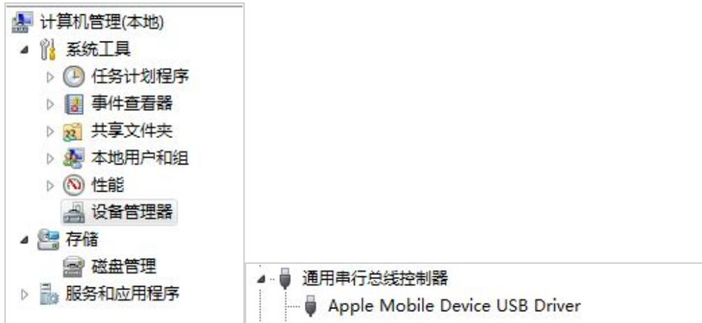
之后，拔出USB数据线，重新插入一次。系统会自动检测新硬件设备并安装驱动。再次连接上iTunes，你就会发现自己的iPhone被识别出来了。
